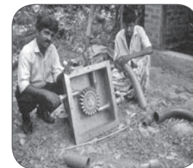
Slika 8. Mikrohidro sistem, dovoljan za snabdevanje tri domaćinstva, Nepal
