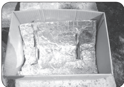
Slika 15. Dno kutije oblikovno i pokriveno aluminijumskom folijom, sa postoljem za flašu.
