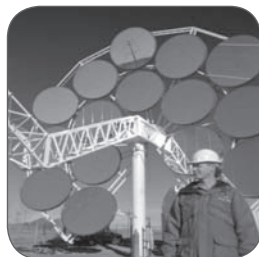
Slika 10. Solarni tanjiri na pokretnom nosaču, prate kretanje Sunca.
